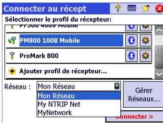
Par la suite, lorsque vous démarrerez un levé, vous devrez indiquer avec quel profil réseau le récepteur doit fonctionner. Sélectionner le nom du profil réseau correspondant.
